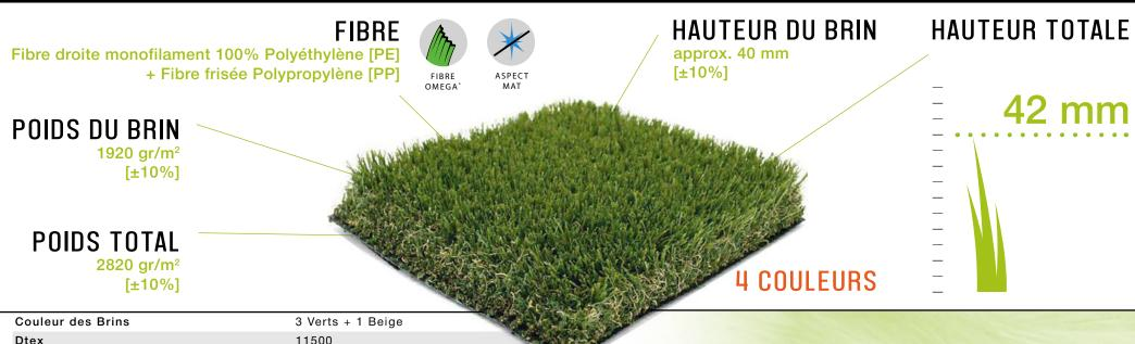
11500 **Dossier Primaire** 100% PP (fibre-lock fleece : antistatique) **Enduction du Dossier** 100% Latex Perméabilité / m² 60 litres / m<sup>2</sup> / min. 3/8" Jauge Nombre de Points / 10 cm 18 ±10% Nombre de Points / m<sup>2</sup> 18900 ±10% Résistance à l'Arrachement > 30 Newton Résistance à la Lumière [échelle de bleus 1-8] > 7 DIN54004 Résistance des Couleurs [échelle de gris 1-5] DIN Standard Largeur des Rouleaux 2 / 4 mètres ±1% Longueur des Rouleaux 25 mètres ±1%
